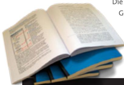
Die Broschierung besteht aus einer Leimbindung mit Gewebeband, das über den Buchrücken umfältelt wird. Als umseitiger Buchdeckel wird ein farbiger Lederkarton oder ein bedrucktes Deckblatt in Kartonstärke verwendet.
